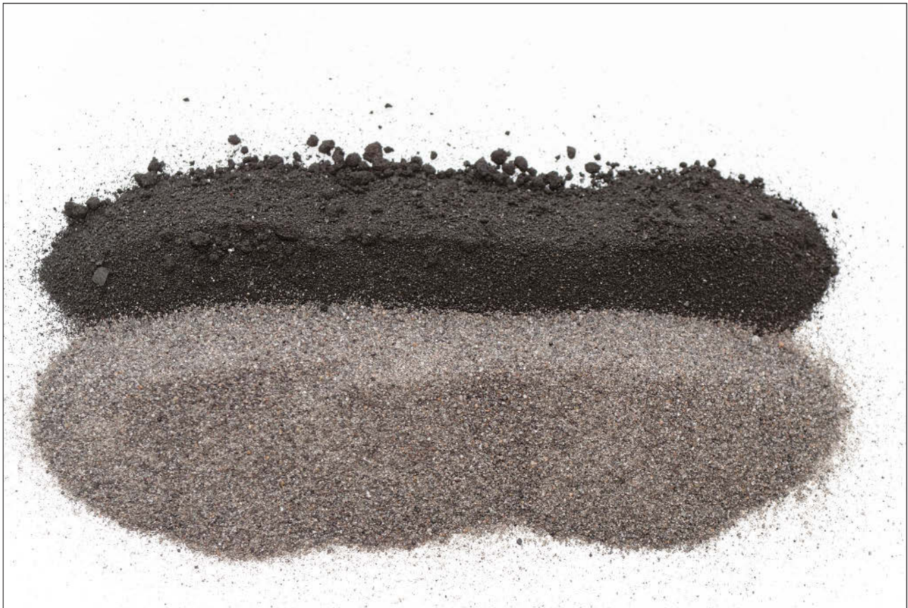
Sichtbar regeneriert: Altsand (oben) im Vergleich zum Regenerat (unten).
