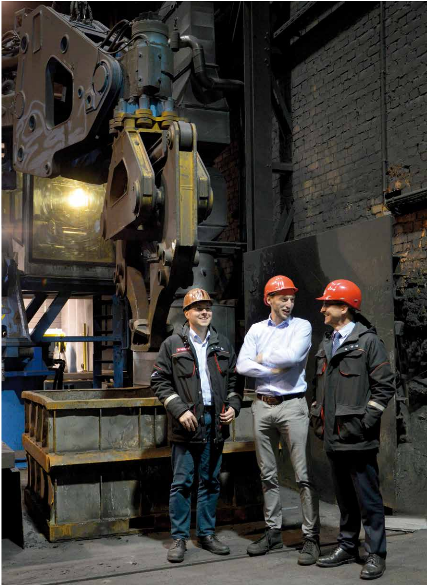
Bild 4: Dieser speziell entwickelte Manipulator trennt Formkästen und Gussteile. Im Vordergrund: Martin Severing (l.), Projektmanager/Leiter Engineering Gegengewichte, und Klemens Raub (r.), Werksleiter Linde Weilbach mit Maurits Brandt, Gemco Engineers.
