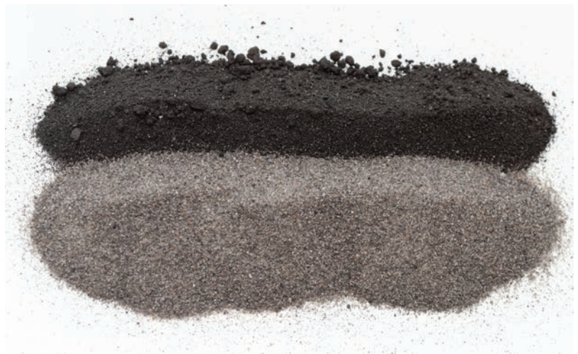
Visiblemente regenerado: arena usada (arriba) en comparación con arena regenerada SandCleaner (abajo)
